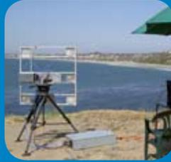
FMCW radar antenna array
